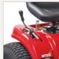
LEVE SEPARATE PER INNESTO LAME E REGOLAZIONE ALTEZZA PIATTO
